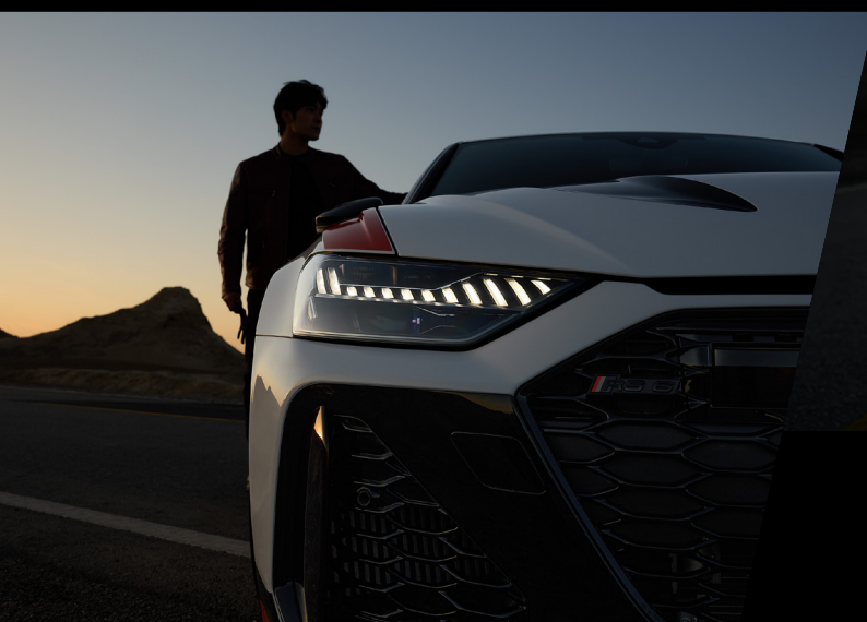
高清激光矩阵式 LED 大灯，带动态转向灯
